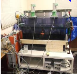
電解析出金属ニッケル 電解析出実証試験装置 硫酸ニッケル晶析物 硫酸ニッケル汚泥 硫化ニッケル空気酸化
